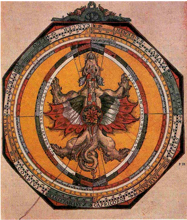
Calculadoras de papel con cuatro discos móviles para predecir eclipses solares y lunares. Del Astronomicum Caesarium de Petrus Apianus, 1540.
